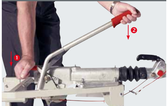
Handbremshebel angezogen = Bremsgestänge gespannt, Handbremshebel abgesenkt
