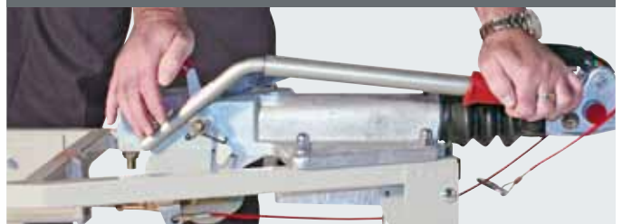
Handbremshebel angezogen = Bremsgestänge gespannt, Handbremshebel abgesenkt
