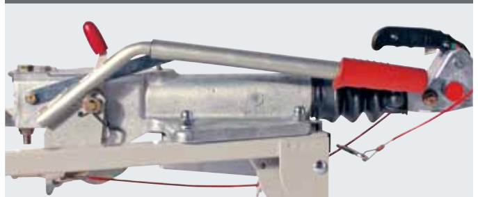
Handbremshebel geöffnet = Bremsgestänge nicht gespannt
